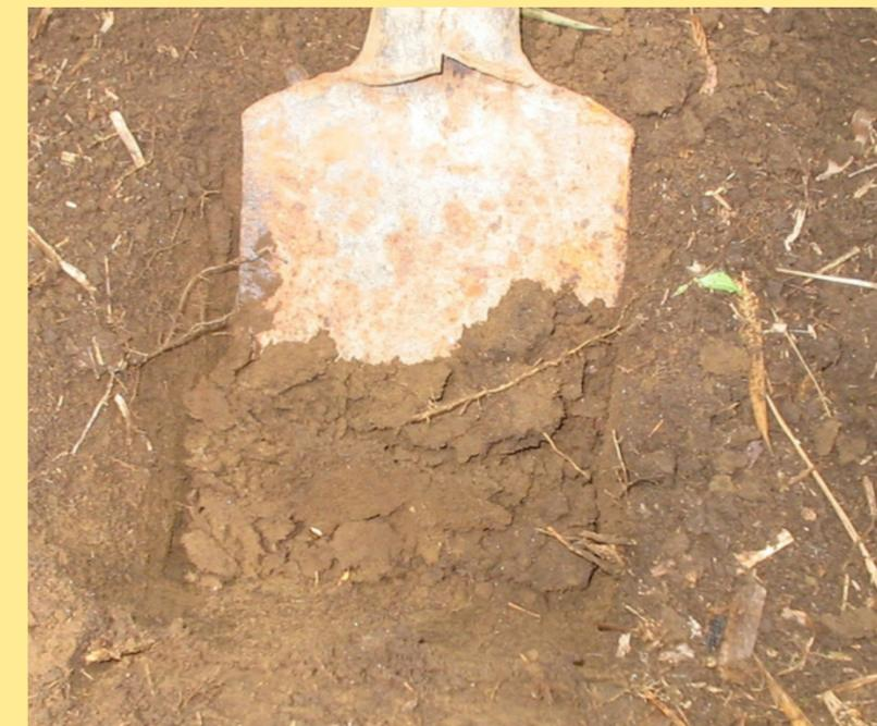
Para realizar el análisis de suelo se realizan entre 10 y 20 hoyos de unos 20 centímetros de profundidad en forma de triángulo o V. Luego se mezcla la tierra y se lleva una muestra en un balde.
